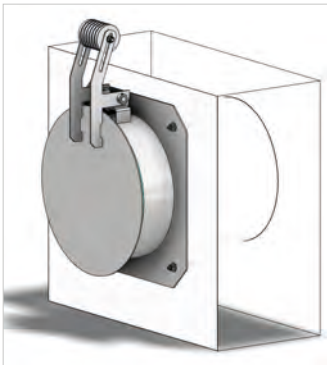
■ GW-RDD_HG: Rückstauklappe mit Hebel und Gegengewicht / GW-RDD_HG: flap valve with lever and counterweight
